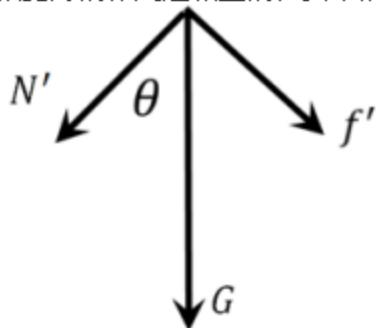
$N'$ 水平方向的力为方向向左的  $N'\sin\theta = mg\cos\theta\sin\theta$ ,  $f'$ 水平方向的力为方向向右的  $f'\cos\theta = f\cos\theta$ , 货车水平向上受到  $N'$ 和  $f'$ 的合力为  $N'\sin\theta - f'\cos\theta = mg\cos\theta\sin\theta - f\cos\theta = (mg\sin\theta - f)\cos\theta = macos\theta$ , 方向水平向左。
