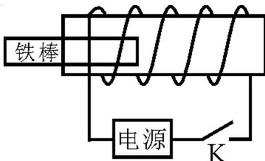
A、闭合电键时铁棒被吸入螺线管内，断开电键铁棒不动
