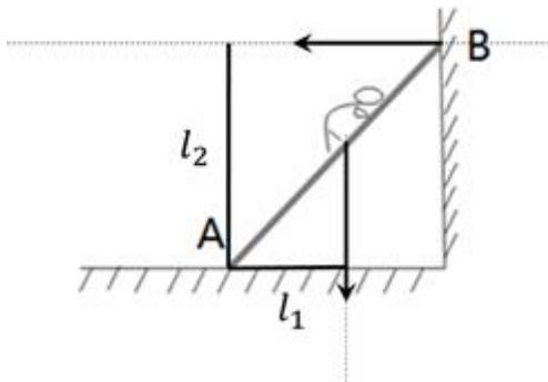
将梯子看成轻质杠杆，A 点为支点，将人的重力看成动力，墙对梯子的支持力看成阻力，随着人向上走，重力不变，但动力臂  $l_1$  变大，而阻力臂  $l_2$  不变，根据平衡状态下， $动力 \times 动力臂 = 阻力 \times 阻力臂$ ，可以推出阻力变大，即墙对梯子的支持力变大，梯子对墙面的压力也变大。
